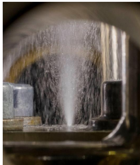
Abbildung 7: Flüssige CO 2 -Fontäne bei einem Gegendruck von 30 bar und einer Probestischtemperatur von 0°C.
