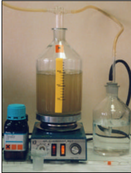
Abb. 2.3: Rührkolben zur Kultivierung von 3-CBA- bzw. 4-CP-abbauenden Bakterien
